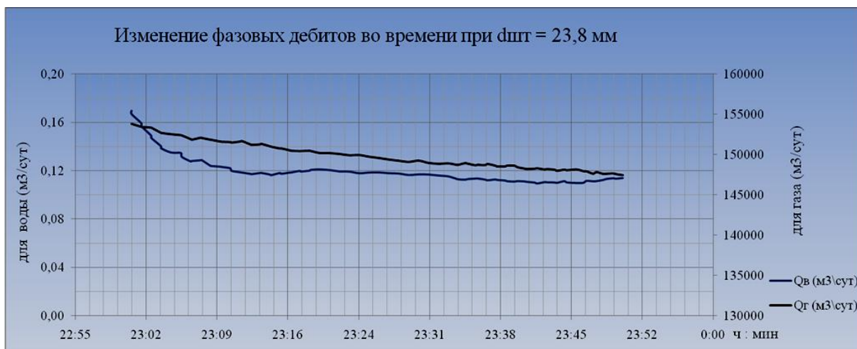
Рисунок 2. Мониторинг дебита воды многофазным расходомером «Rohag» на скважине ООО «Газпром добыча Уренгой»
